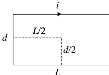
Campo magnético produzido por uma corrente  $i$  que trafega num segmento de fio de comprimento  $a$ , a uma distância  $b$  ortogonal ao centro do segmento (lei de Biot-Savart):
